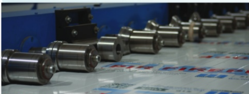
Profiling : Wall Tech เลือกใช้ลูกกรีดแบบ Cassettes ที่มีความเสถียรและแม่นยำสูงในการขึ้นรูปรอยต่อต่างๆ
