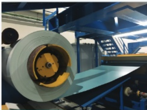
Uncoiling : การไหลแผ่นเหล็กเข้าเครื่องจักรอย่างมีประสิทธิภาพแผ่นเหล็กไม่เกิดการเสียวหรือบิดเบี้ยว ทำให้การขึ้นรูปรอยต่อแผ่นสมบูรณ์ จึงทำให้แผ่นฉนวนที่ได้มีคุณภาพสูง
